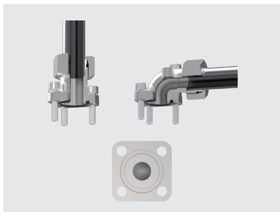
I raccordi con attacco a flangia quadrata si distinguono per le loro dimensioni esterne particolarmente ridotte. Queste vengono fornite nella versione diritta o a gomito. Il programma comprende i diametri esterni per tubi da 10 mm a 42 mm. La tenuta della flangia viene realizzata con un anello di tenuta circolare elastico (O-Ring) e l'attacco di montaggio con viti a testa cilindrica. Gli attacchi della flangia sono secondo lo schema fori dei produttori di pompe più rinomati.
