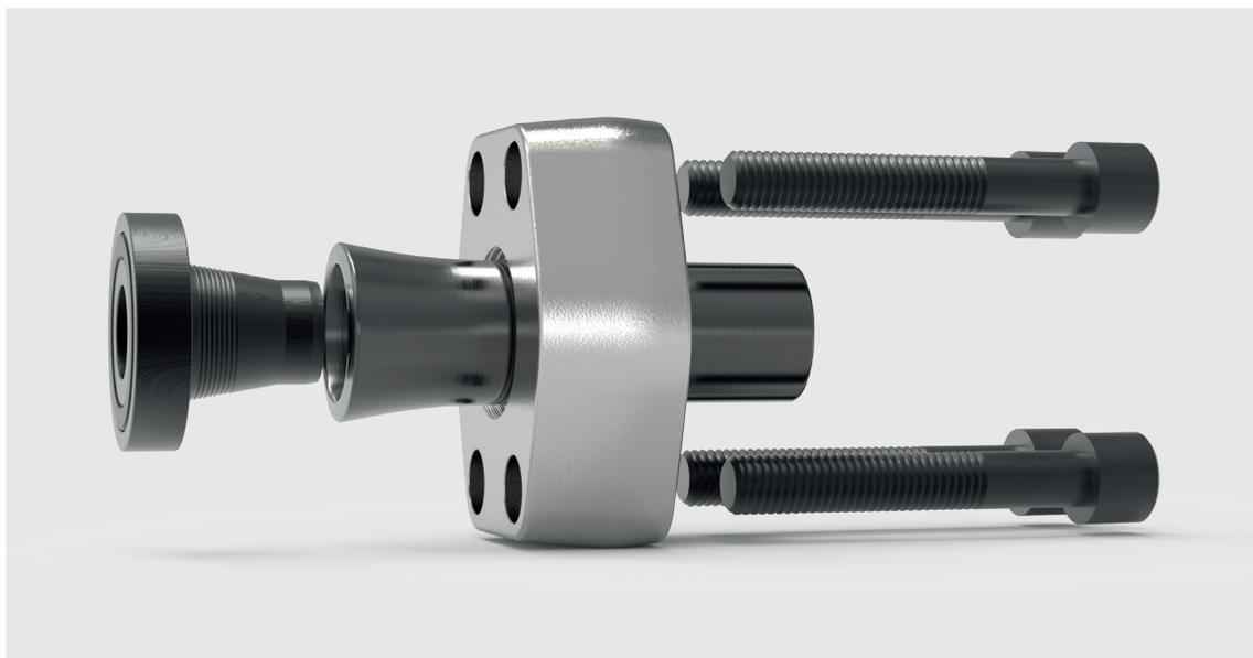
A confronto dei tradizionali angoli di svasatura a 37°, i sistemi a flangia ZAKO sono costruiti con un angolo di svasatura a 10° con una piccola zigrinatura a dente di sega nella zona svasata. La nostra pluriennale esperienza con questo sistema in combinazione con innumerevoli test di controllo in pressione hanno dimostrato considerevoli
