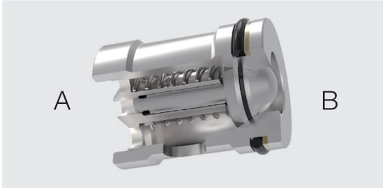
Come elemento ad innesto in piastre o direttamente in apparecchiature di macchine oleodinamiche le valvole di non ritorno a cartuccia VOSS consentono al flusso il movimento in una direzione e lo bloccano in quella opposta.
